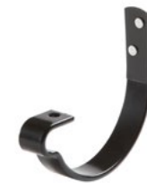
Montāžā attālums starp āķiem ne lielāks kā 800-900 mm.
