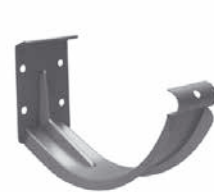
Montāžā attālums starp āķiem ne lielāks kā 600 mm.
